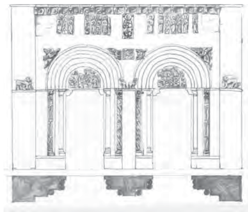
Fig. 28. Reconstrucción hipotética del primer proyecto de bífora de la fachada de Platerías de la Catedral de Santiago, nunca realizado (1101-1103). Dibujo: Victoriano Nodar bajo asesoría de M. Castiñeiras.
